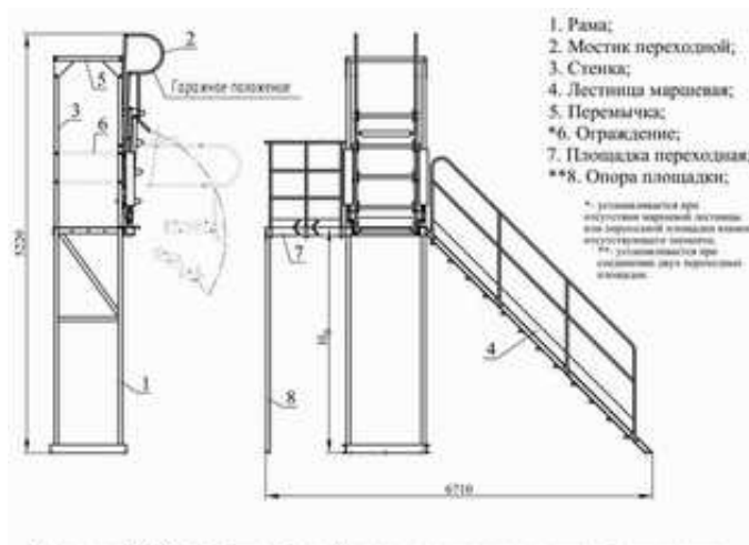
Рисунок 1 - Общий вид базовой компоновки площадки обслуживания
