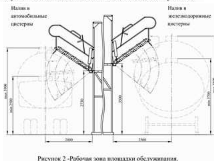
Рисунок 1 - Общий вид базовой компоновки площадки обслуживания
